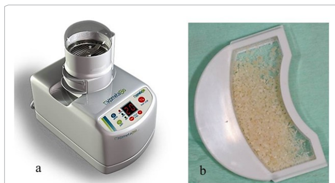
Obrázek 2: Mlýnek na dentin a zásuvka s rozdrčenou zubovinou velikostí 300 - 1200um připravená pro čistící proces. a) MND a třídící b) Zásuvka, v níž se shromažďuje rozdrčená zubovina po rozemletí a vytřídění. Velikost částic je 300 - 1200um.
